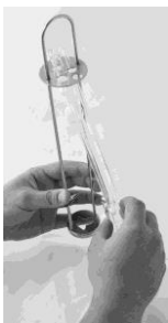
Abb. 4 Einführen bzw. Austauschen eines Viskosimeters mit Lichtschrankenabtastung
